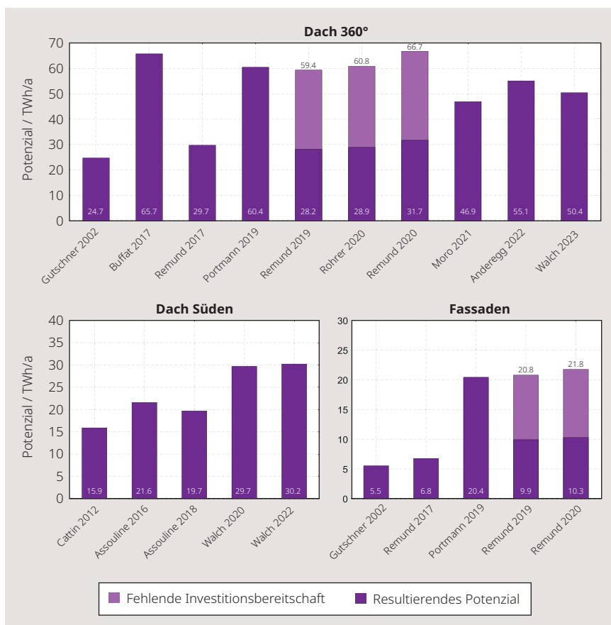
Bild 3 Resultate der Potenzialstudien, umgerechnet auf einen einheitlichen Wirkungsgrad.
