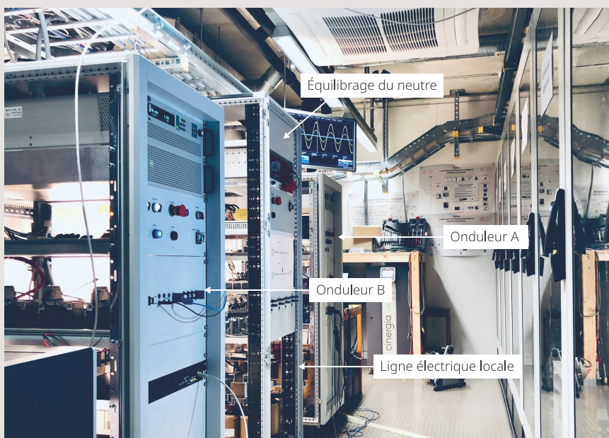
Figure 3 Onduleurs grid-forming et système d'équilibrage du neutre intégrés dans le laboratoire ReIne.
