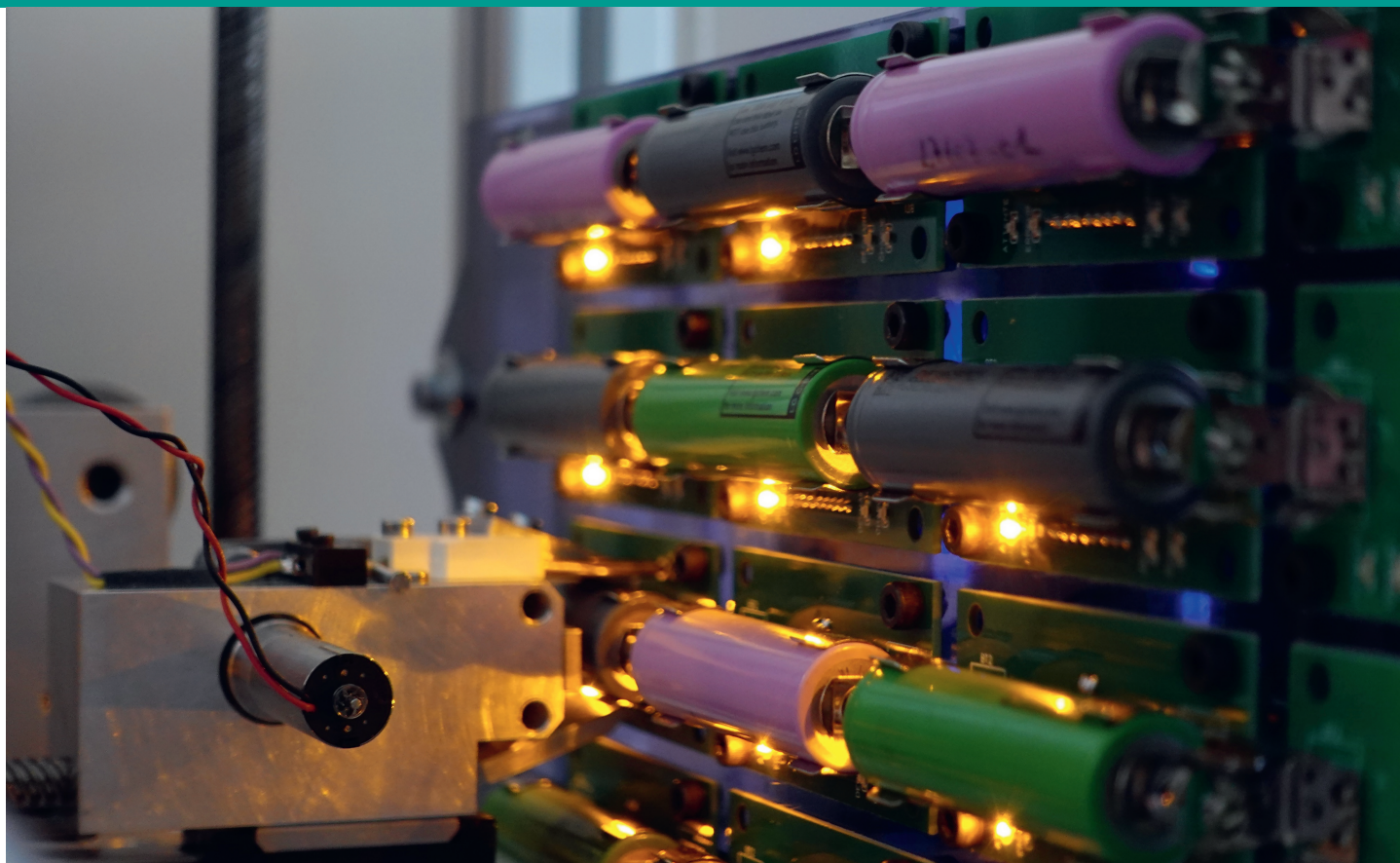
Robot permettant de tester les cellules INR18650.
