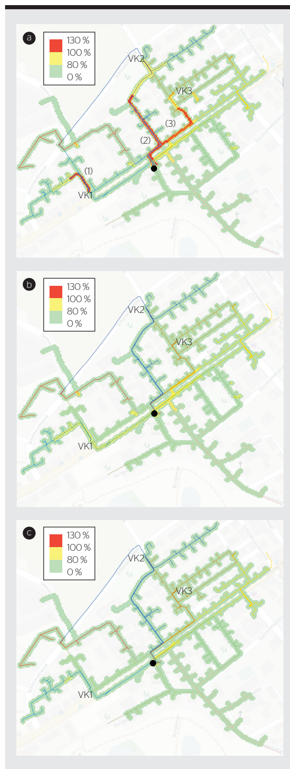
Bild 5 Darstellung der Ergebnisse des Stresstests in der Oberfläche von Neplan V10: a) Stresstests für das Jahr 2032 ohne Massnahmen, b) Stresstests für das Jahr 2032 mit Massnahmen und c) Stresstests für das Jahr 2050 bei Abregelung aller Ladeinfrastrukturen auf 3,7 kW mit Massnahmen.
