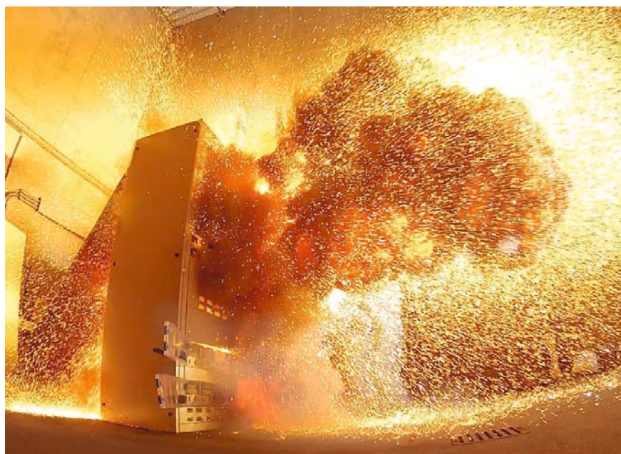
Störlichtbogenprüfung ohne Schutzmassnahmen.
