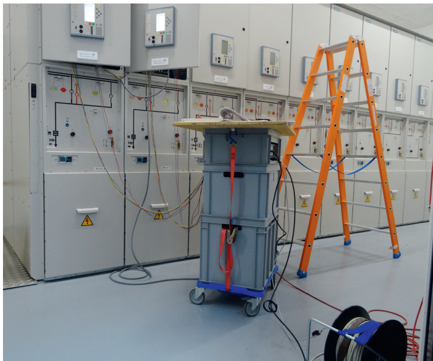
Bild 5 Verbindung der CMC-Prüfgeräte mit den HV/MV-Einspeisungen im Umspannwerk, die konventionelle Strom- und Spannungswandler verwenden.
