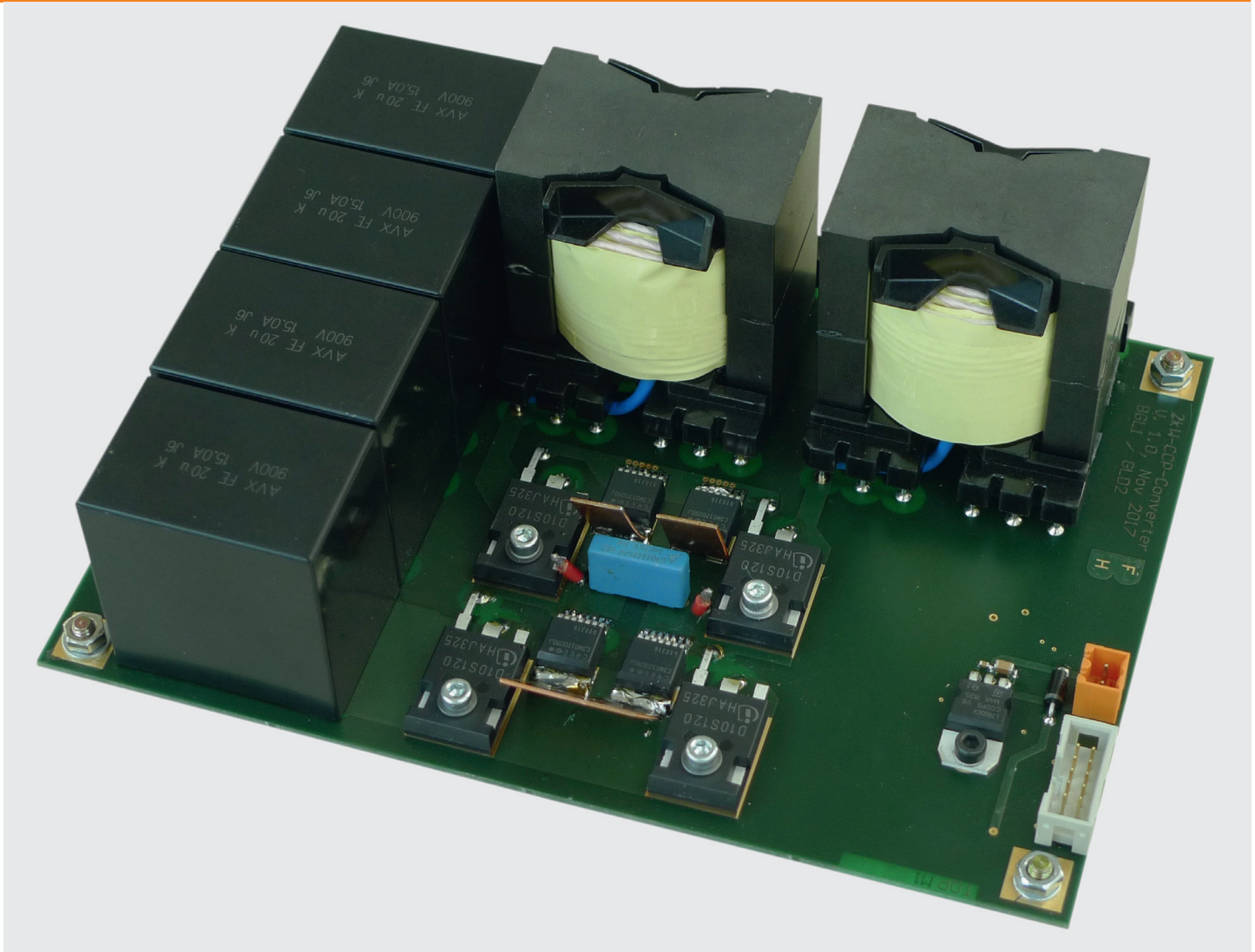
Prototyp eines bidirektionalen Borgna-Konverters mit 2 kW Nennleistung.
