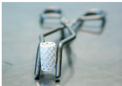
Bild 6 Prototyp eines strömungsoptimierten polyedrischen Abgaskatalysators.
