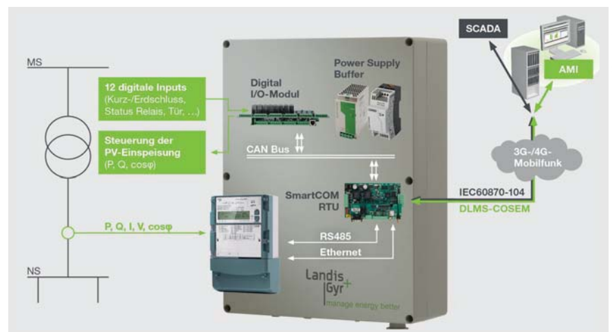
Bild 4 Systemarchitektur der Smart-Grid-Lösung: Die betriebsrelevanten Messdaten werden im SCADA-System visualisiert, wobei die 15-min-Energieabrechnungsdaten mit der gleichen IP-Adresse von der Advanced-Metering-Infrastruktur (AMI) abgelesen werden. Die Steuerungsbefehle werden aus dem Leitsystem durch das I/O-Modul realisiert.
