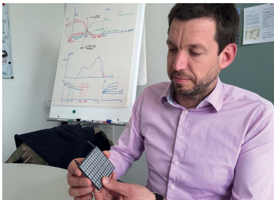
D r Corsin Battaglia, ici avec un générateur thermoélectrique commercialisé à base de tellure de bismuth, étudie à l'Empa diverses applications thermoélectriques.
