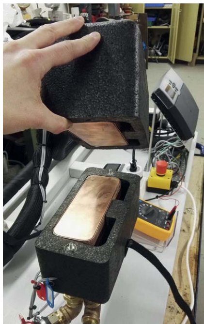
Démonstrateur d'une puissance de transmission thermique de 1 kW tel qu'il a été construit dans le contexte de l'étude de l'OFEN sur la thermo-électricité. Photographie de l'échangeur thermique sectionné pour l'intégration d'un élément thermoélectrique.
