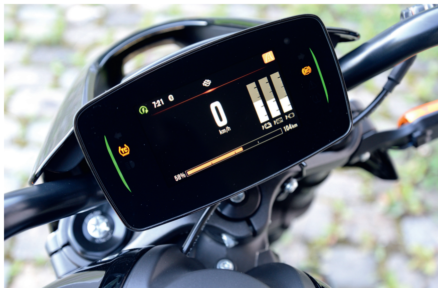
Klar und aufgeräumt: Das Display informiert über Wesentliches und kann Zusatzinfos wie die Temperaturen von Batterie, Leistungselektronik und Motor anzeigen.
