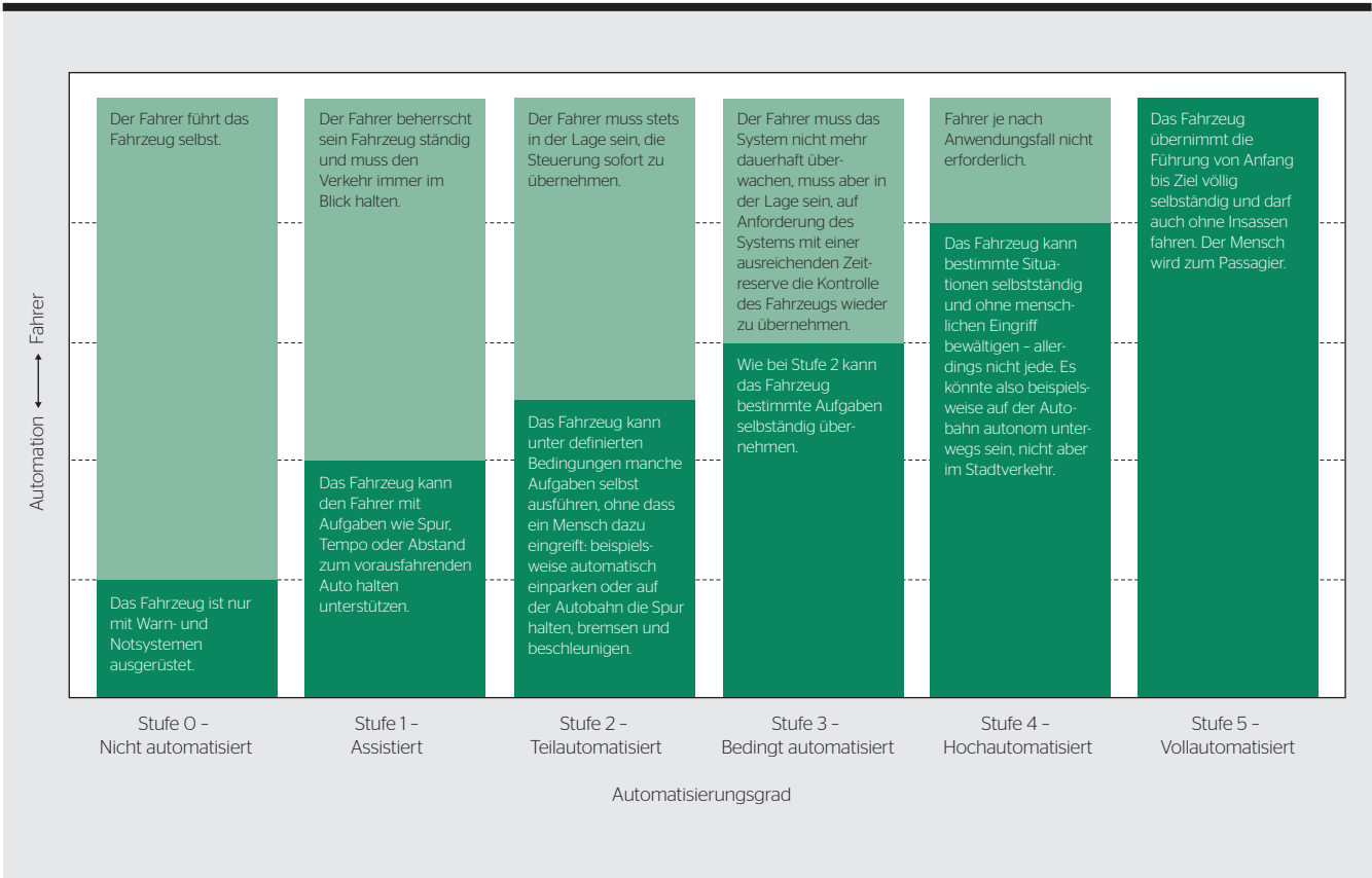
Die Automatisierungsstufen der Society of Automotive Engineers SAE: von «nicht automatisiert» bis «vollautomatisiert».
