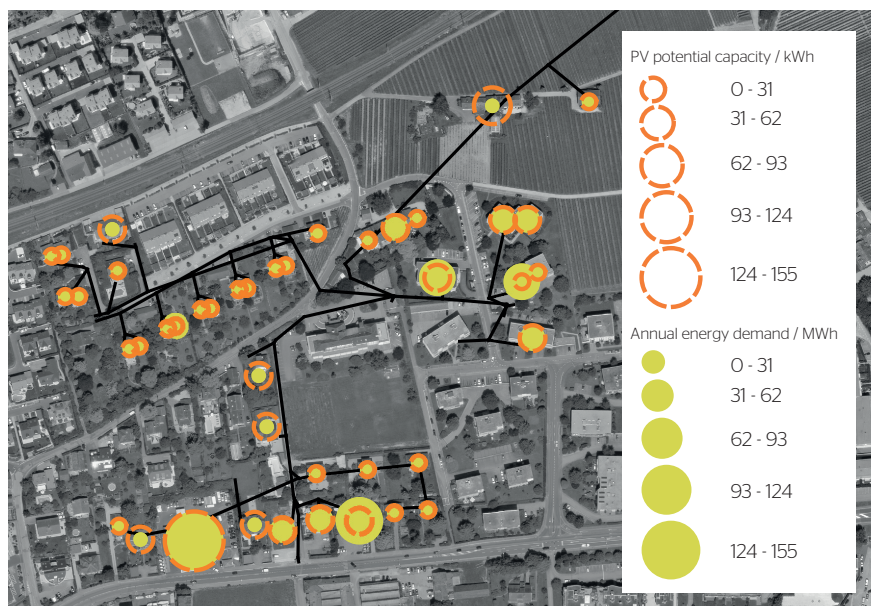
Figure 1 Image du réseau basse tension considéré à Rolle : la taille des disques jaunes représente la demande annuelle en électricité et celle des cercles orange le potentiel de capacité PV.
