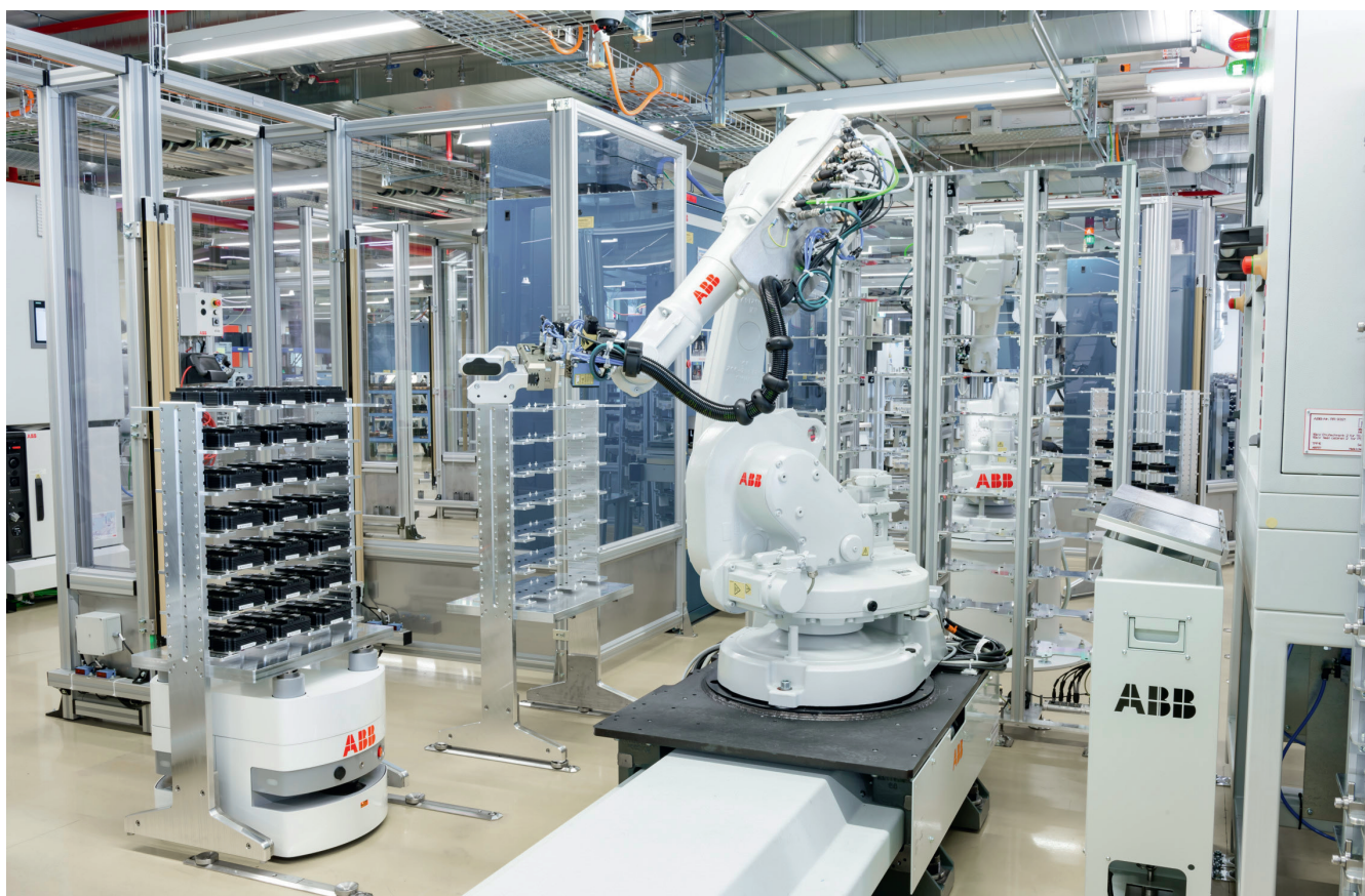
Un AGV (Automated Guided Vehicle) alimente une cellule robotisée avec un module semi-conducteur.
