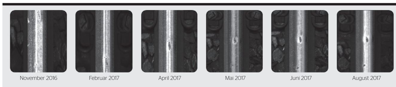
Bild 6 Zeitlicher Verlauf eines mit Fingerprinting gefundenen Fehlers.
