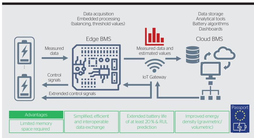
**Statistical Data Frame (SDF):** Das an der BFH entwickelte Konzept für die statistische Erfassung von Daten über die Nutzung von Li-Ionen-Batterien.
